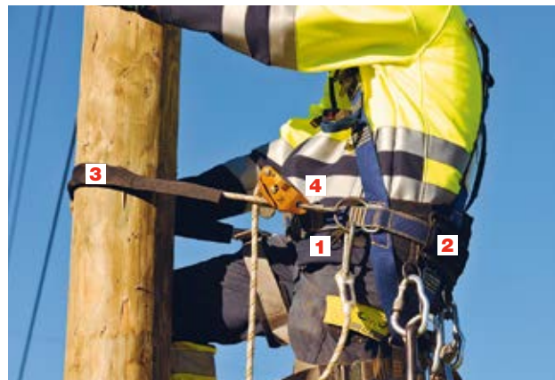
5 Gurt zum Besteigen von Masten mit Halteseil und Längeneinstellvorrichtung («Seilkürzer»). Der «Seilkürzer» ermöglicht das Einstellen der Länge des Halteseils.
